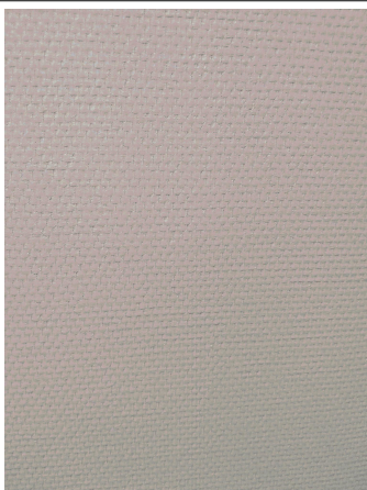
Prélèvement - P005 : R+1 / S 1.44 - Bande de plaque de plâtre- (Absence d'amiante)
